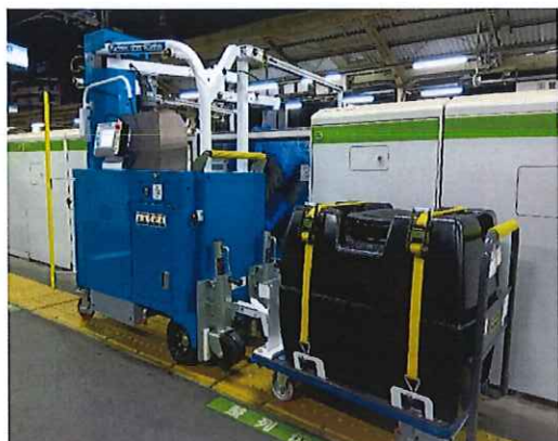
ホーム側から見た「ホームドア・ウォッシャー（線路側）」
