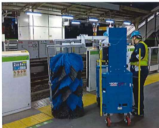
前から見た「ホームドア・ウォッシャー（線路側）」
