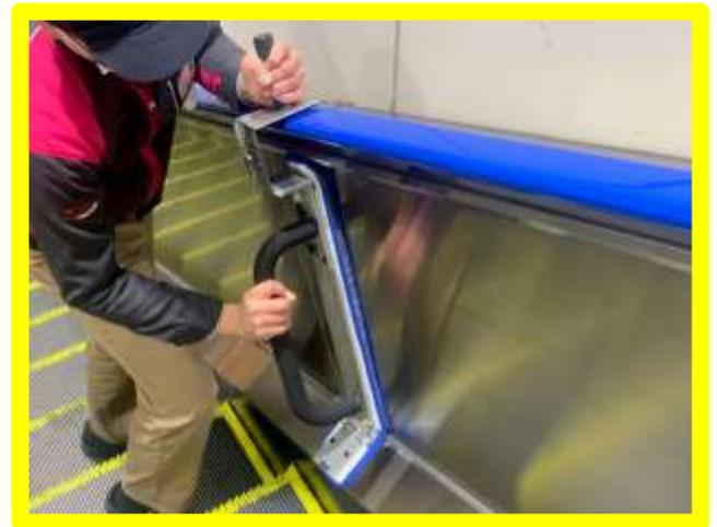
稼働しているエスカレーターに、エスカモップを持ち壁面に押し当てることにより、サイドパネルとデッキカバーを同時に拭き上げることができる製品です。エスカモップを活用することで、作業負担の軽減および時間の短縮が期待できます。
